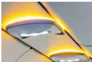
**Le PaxPod PSU lumineux intègre, en un design particulièrement élégant, un bloc service passager (PSU) et un éclairage d'ambiance.**
